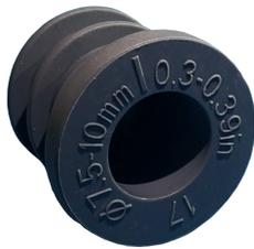
Die Einstecktülle wird für Kabel ohne RJ-45-Stecker verwendet. Die Tülle ist für ein einzelnes rundes Kabel geeignet, nicht geeignet für flache oder verformte Kabel.
